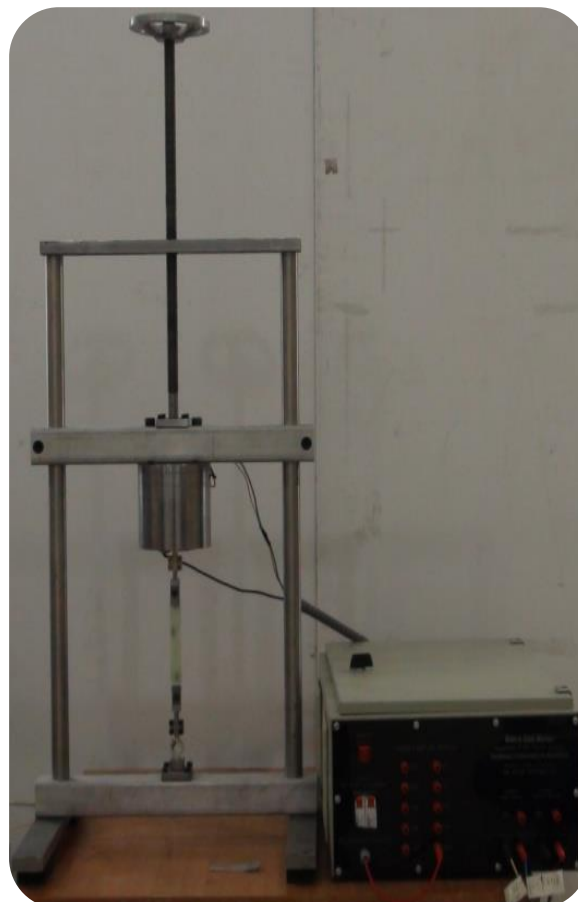
دستگاه تست خستگی برقی فرکانس بالا
